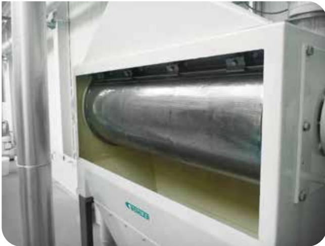
Maximale Ausbeute durch effiziente Trennung der anhaftenden Mehlteile von der Kleie.
