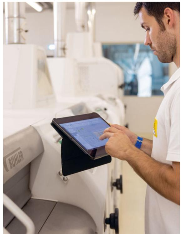
Gianluca Sinigaglia, Obermüller bei Molino Quaglia, kann jeden einzelnen Produktionsparameter der Mühle auf seinem Tablet in Echtzeit überwachen.
