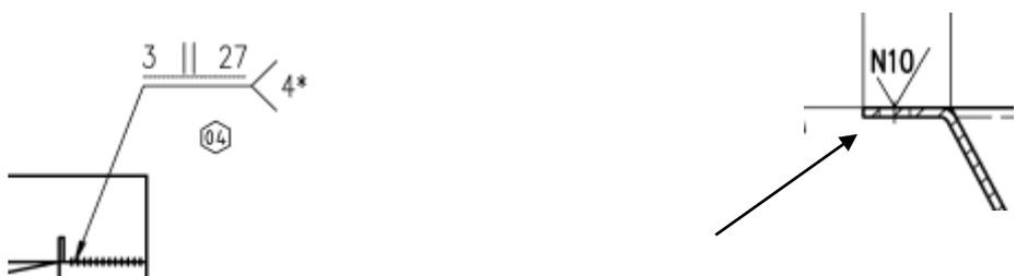
Eine Gegenlage verhindert eine Rissbildung, wenn die Schweissnaht eben geschliffen wird.
