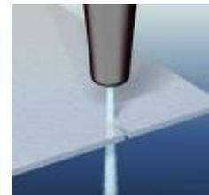
Je nach Einsatzbereich, Reinwasserstrahlschneiden oder Abrasivwasserstrahlschneiden, liegt die Schneiddicke max. bei 200 mm.
