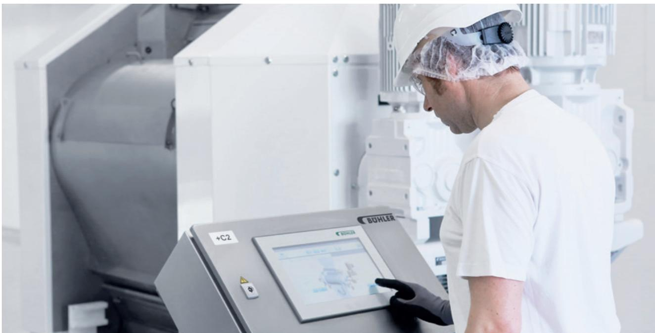
Система управления EasyFlake с интерфейсом на базе сенсорного экрана обеспечивает простоту и безопасность настройки производственных параметров.
