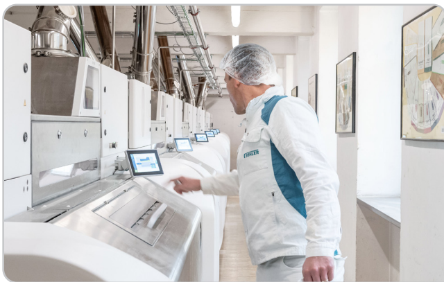
Arrius, ein integriertes Mahlsystem, verbraucht weniger Energie bei höherer Mahlleistung.
