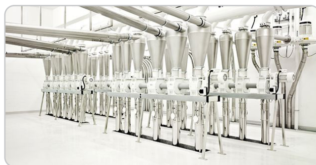
Die Pneumatik und Aspiration in der Mühle sollten über automatische Regelkreise angepasst werden, um den genauen Anforderungen an Druck und Luftfluss gerecht zu werden.
