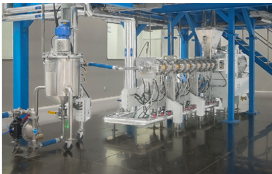
Das Herzstück von Bühlers Batteriemischsystem ist ein Zweiwellenextruder.
