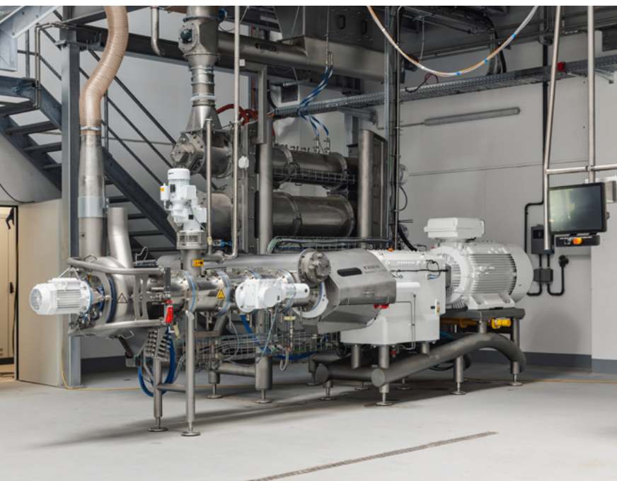
Der neue Nutrex 7 Series- Zweiwellenextruder besticht durch verkürzte Reinigungszeiten dank seines hygienischen Designs.
