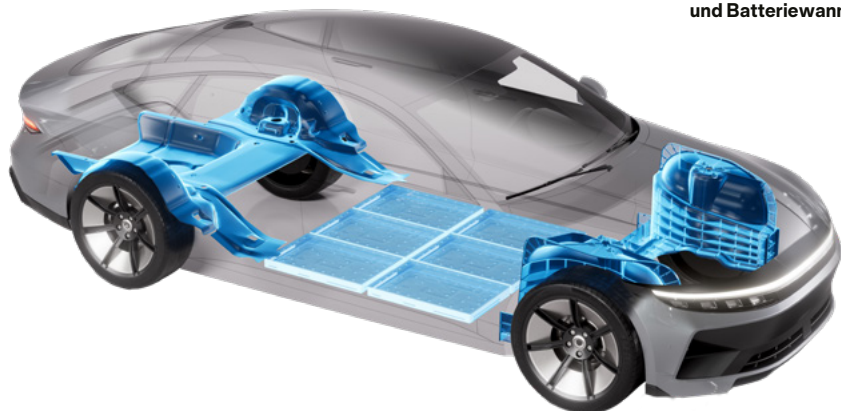
Megacasting-Teile: vorderer Unterwagen, hinterer Unterwagen und Batteriewanne.
