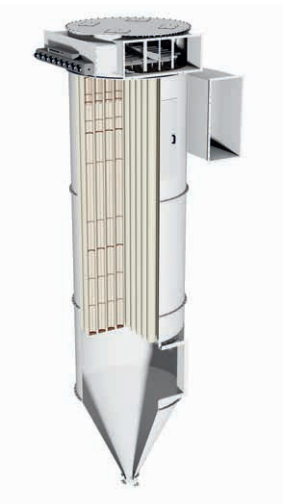
Convient pour les poussières sèches non agglomérées. Entrée d'air par le haut.
