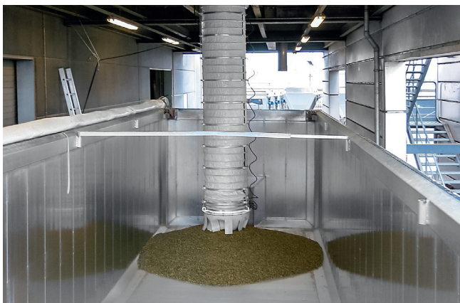
Открытая загрузка: при увеличении объема сыпучего материала разгрузчик автоматически поднимается.
