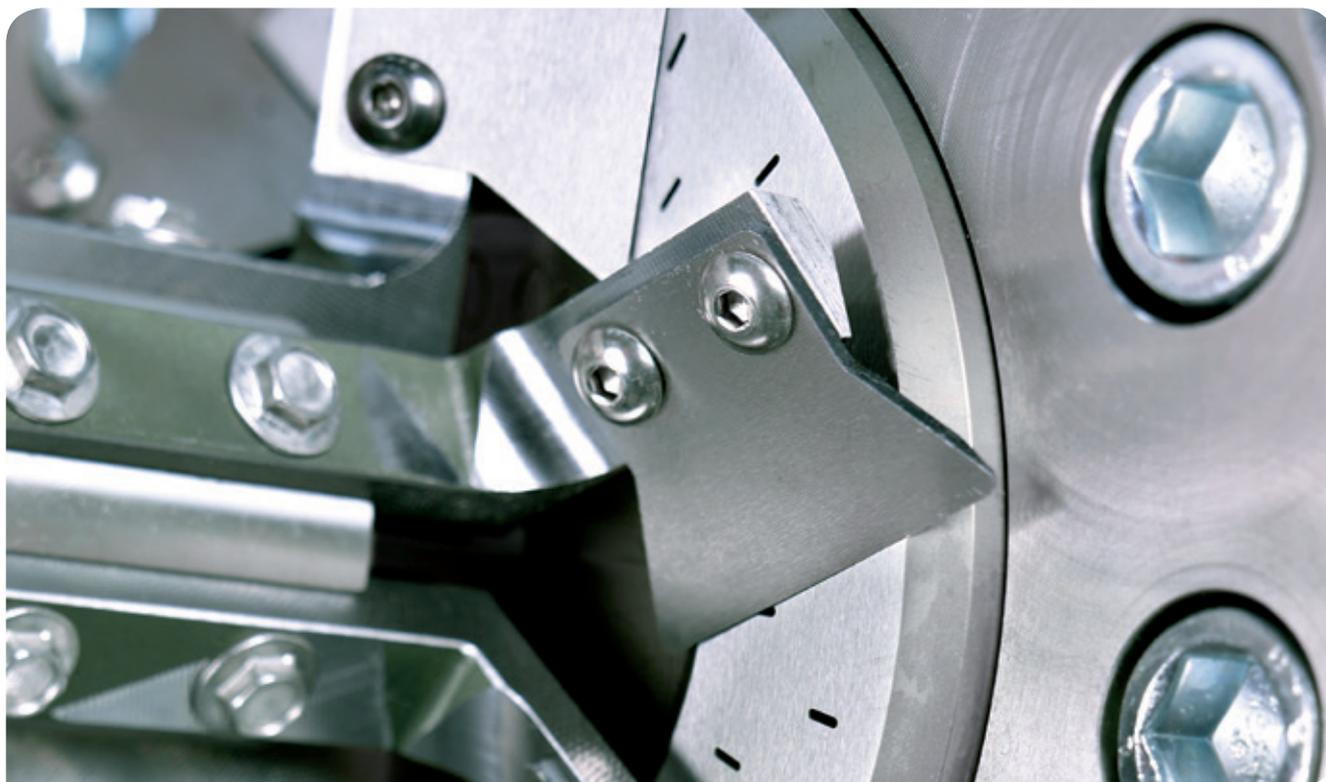
L'appareil de coupe à déplacement latéral permet le remplacement de la tête de coupe peut être remplacée même en cours de production.
