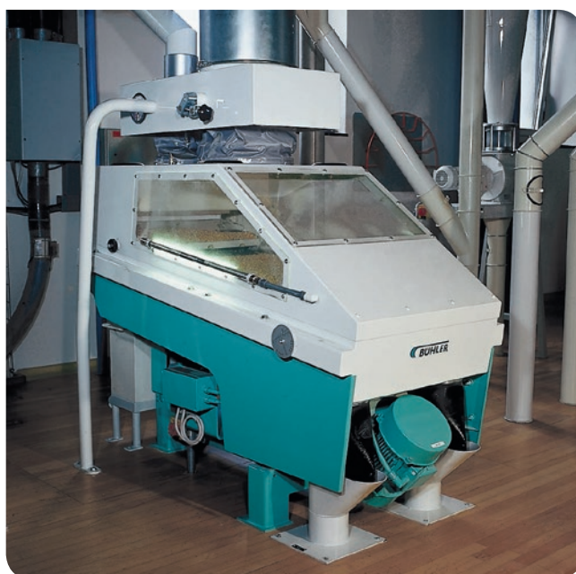
MTSD камнеотборник для эффективного отделения камней и щебня
