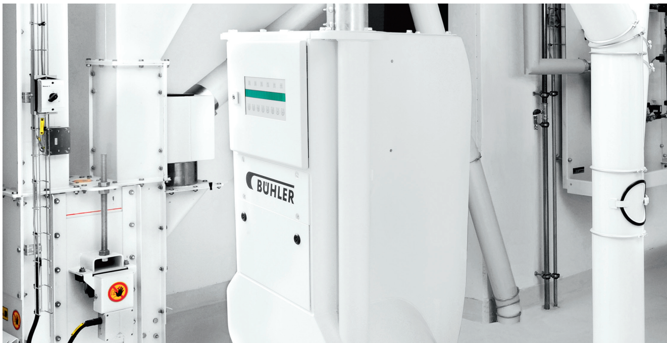
Точное определение влажности с помощью устройства измерения влажности MYFD.
