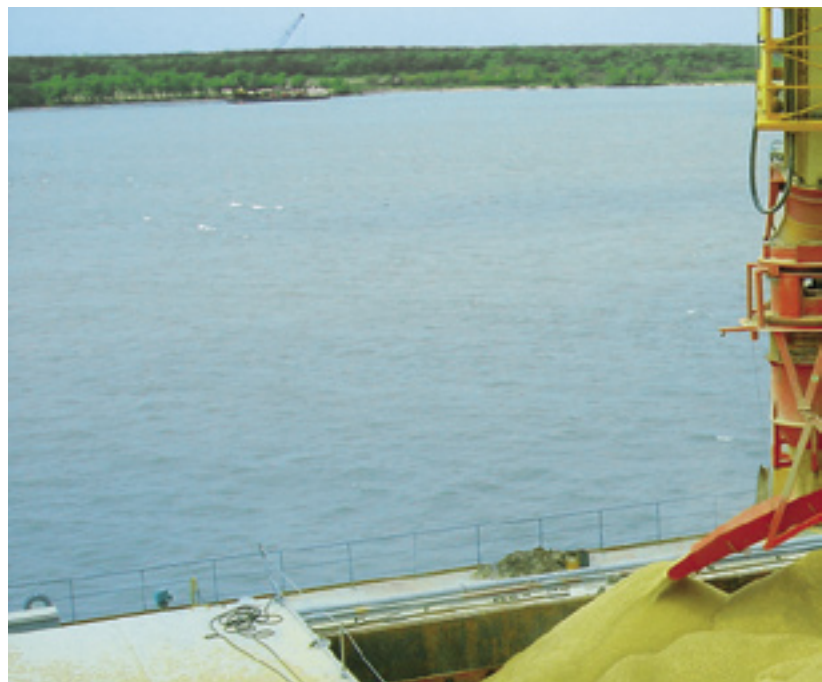
Beladerohr-Staukopf RGLZ-1000, Ausführung für Beladedurchsätze bis 2000 t/h Getreide. Der Staukopf ist mit einer Verteilrutsche ausgerüstet, die um 360° drehbar ist und somit die optimale Lukenbefüllung ermöglicht.
