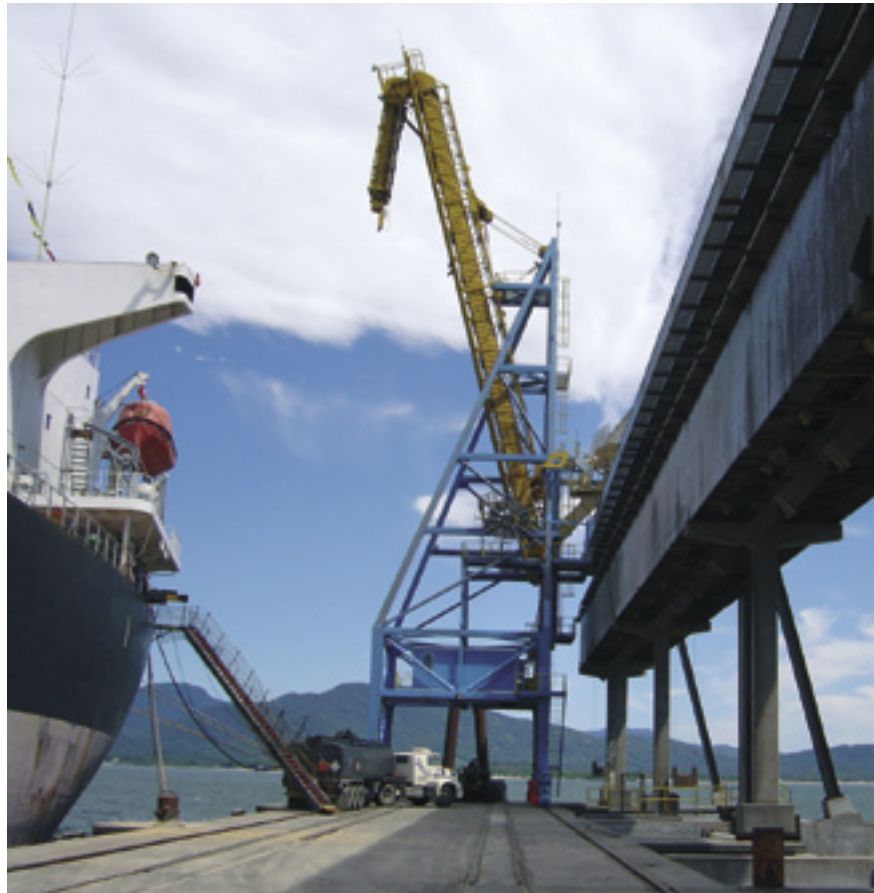
Bunge Alimentos S.A., San Francisco do Sul, Brasilien. Verfahrbarer Schiffsbelader, Durchsatz 2000 t/h Sojabohnen/Weizen oder 1500 t/h Sojamehl.
