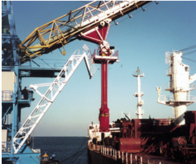
Muuga Grain Terminal, Tallinn, Estland. Schiffsbelader mit Beladerohr-Staukopf RGLZ.
