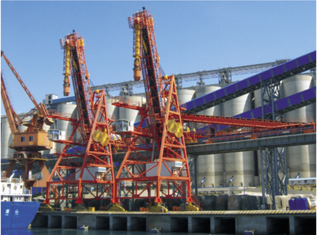
Grain Terminal Dalian Beiliang, China. Schiffsbelader 2×1000 t/h.
