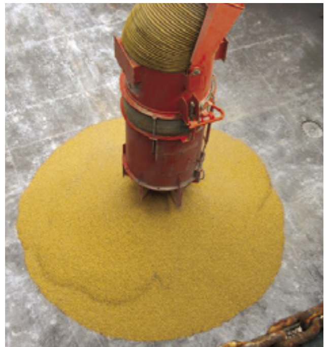
Staukopf mit Gelenk für eine staubarme Beladung.
