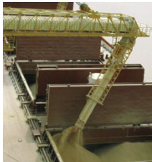
Grosser Kickwinkel ermöglicht die optimale Lukenbefüllung.
