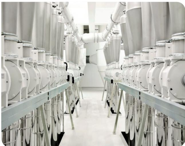
Мельничный пневмотранспорт: группа шлюзовых затворов с циклоном и разгрузочный шлюзовой затвор MPSN.
