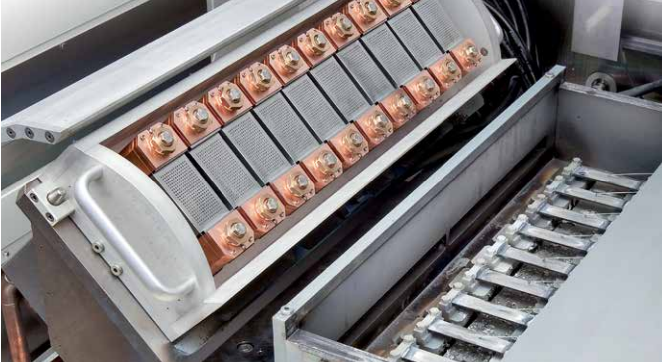
Испарительная станция с испарителями сульфида цинка и алюминия
