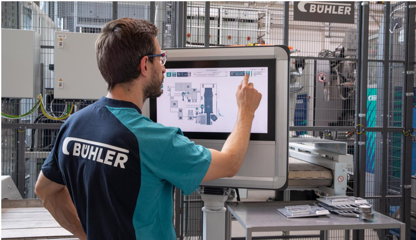
SmartCMS ermöglicht es Ihnen, die gesamte Druckgiesszelle von einem zentralen Ort aus zu steuern.
