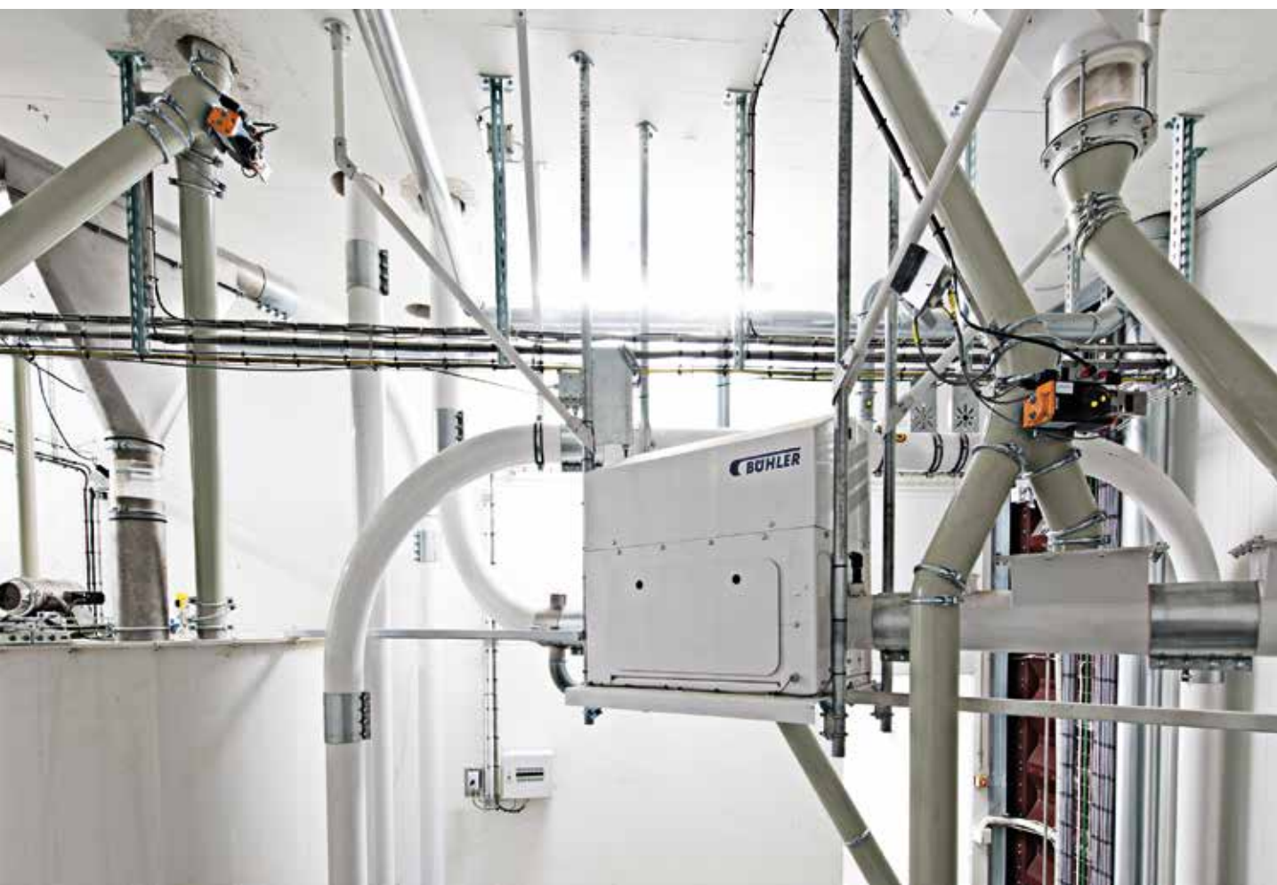
Tubo – hier bei der Brauerei Locher installiert – bietet eine rückstandsfreie und schonende Produktförderung.
